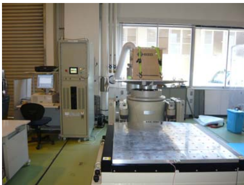
【振動試験機（全景）】
